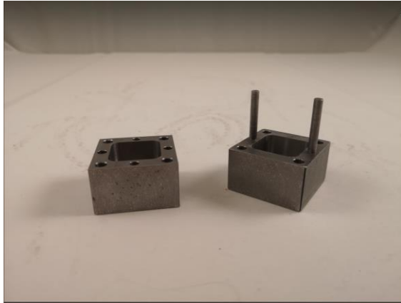
Figur 13. Delad gjutform med styrpinnar.
