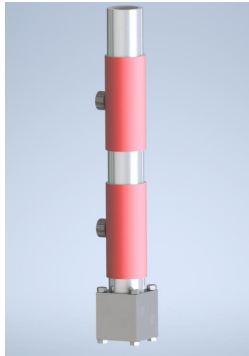
Figur 11. Gjutform applicerad på extrudern.
