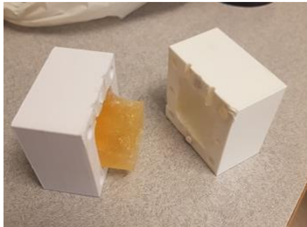
Figur 3. Efter härdning med epoxilim i prototyp gjutform med styrypinnar.
